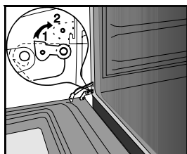
1 Петля дверцы при нормальном использовании
